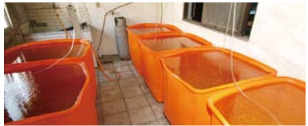
事先養水的大塑膠桶，正在進行曝氣的動作。
