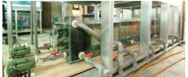
幕後大功臣——底部過濾的裝備。
