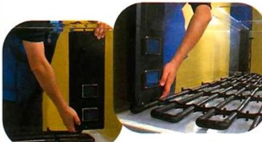
3. 接著，在左、右兩邊缸底放置底部導流管，
